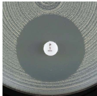
Scharfer Rand mit Durchmesser \geq 26 mm
